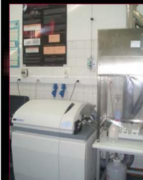
ICP-MS Perkin-Elmer SCIEX Elan 9000, nebulizador "cross-flow", câmara de nebulização "Scott-type" Ryton, cones de Ni, bomba peristáltica 4 canais Gilson. Auto-amostrador Perkin-Elmer AS-93; câmara de fluxo laminar classe 100 (Reinraumtechnik Max Petek) Software Elan 6100 Windows NT (2.4)
